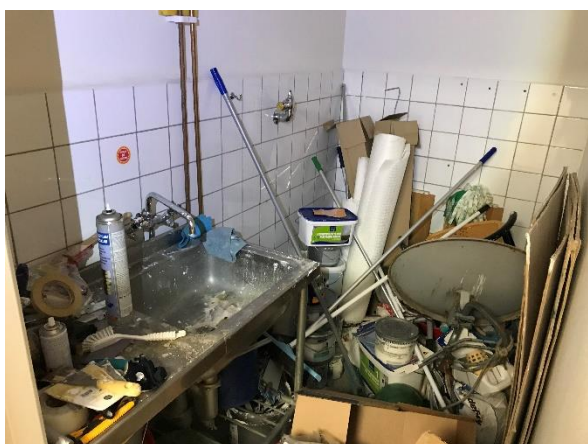
Toalett och våtutrymmen där asbest kan finnas i fogen eller fästbruk bakom kakel och klinkers.
