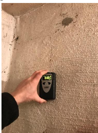
Dokumentation av förekomst av blåbetong. Gamma mätaren ger utslag på 0,48 och gränsvärdet för indikation av blåbetong ligger på 0,35.
